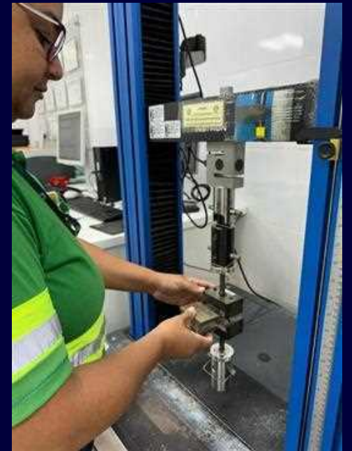
Realização do teste de tração na chapa de MDF.
