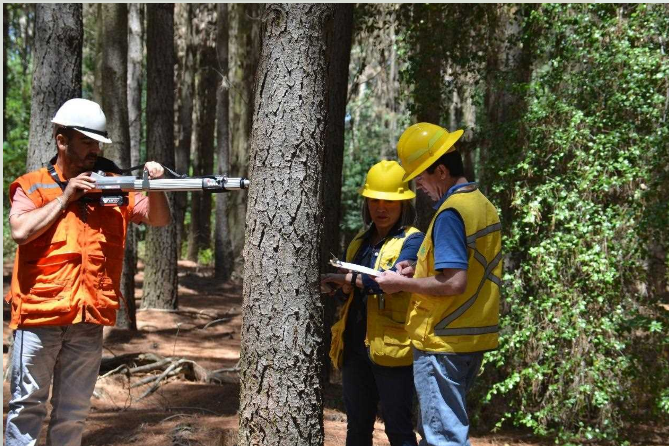
Amostragem com Resistógrafo
