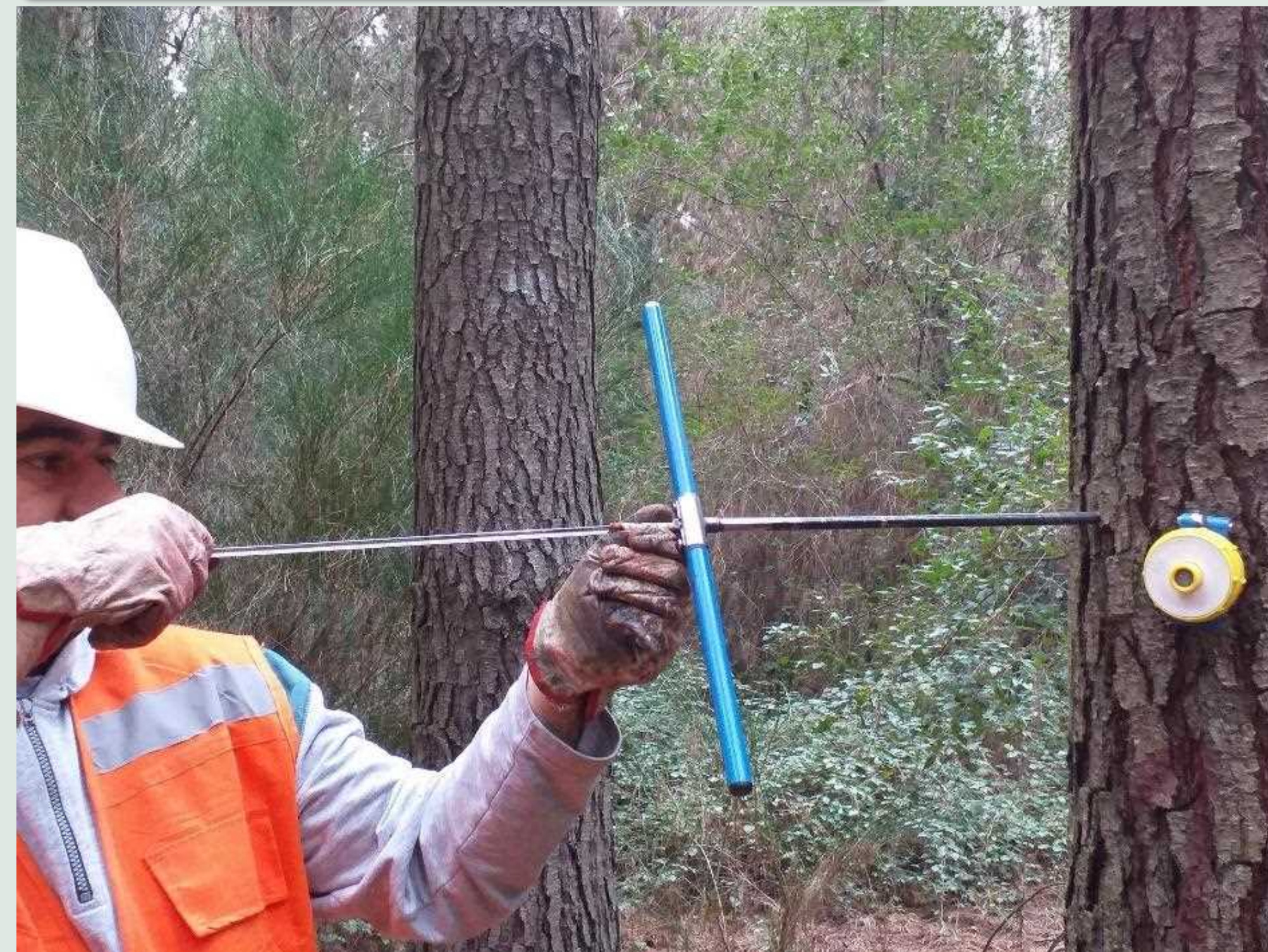
Amostragem com trado de incremento
